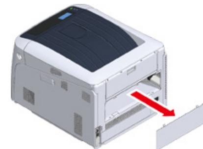
**4** 如图所示，确保双面打印部件的正面朝上，然后将其推入打印机后部的槽中。
