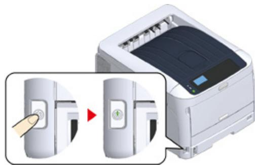
打印机电源开启时，电源开关 LED 指示灯将会点亮。
