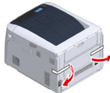
**3** 拆除打印机背面的暗盖。
