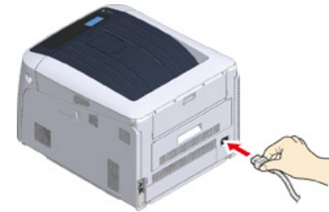
2 将电源线插入电源插座。
