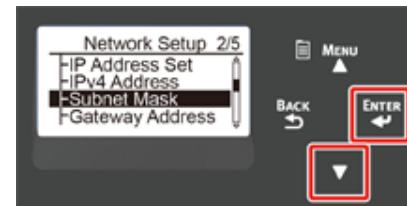
**13** 采用输入 IP 地址的相同方式输入子网掩码。所有输入完成后，按 «BACK (返回) » 按钮。
